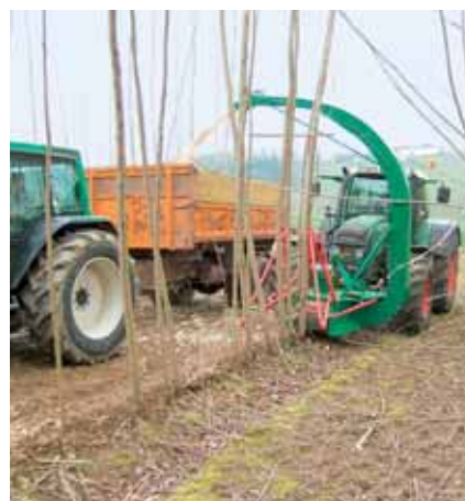
Vollautomatischer Gehölz-Mähacker im Einsatz: Pappel als Energieholz.
